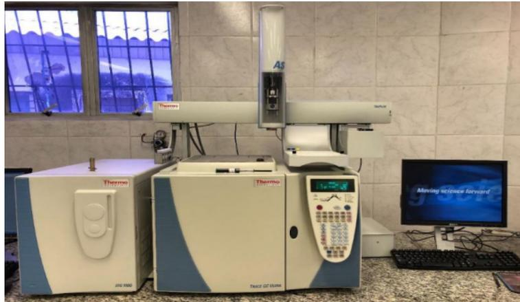
Figura 08: Cromatógrafo gasoso acoplado a espectrômetro de massa
