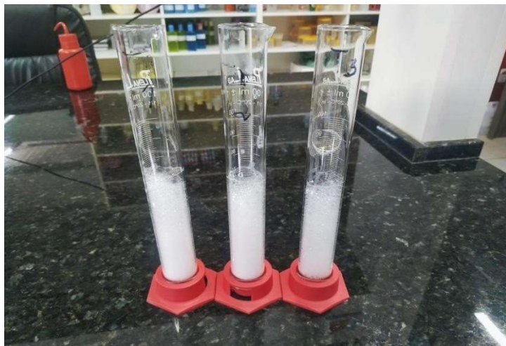
Figura 5 – Teste de formação e estabilidade de espuma. Fonte: autor.
