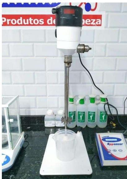
Figura 1 – agitador mecânico utilizado nos testes de formulação de detergente enzimático.
