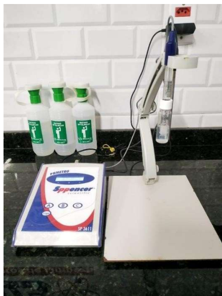
Figura 2 – pHmetro utilizado nos testes de formulação do detergente enzimático.
