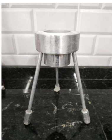
Figura 4 - Viscosímetro do tipo Copo Ford número 4. Fonte: autor.
