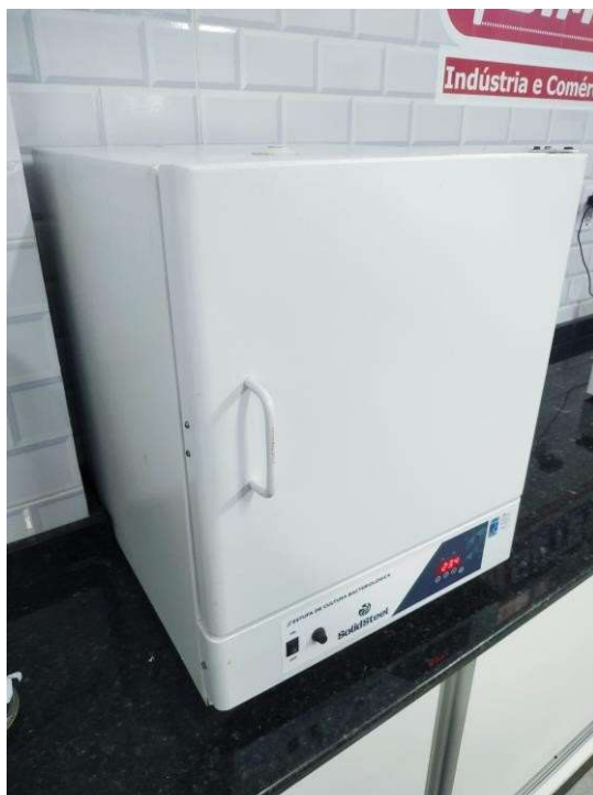
Figura 6 – Estufa utilizada para determinação da estabilidade acelerada do detergente enzimático.
