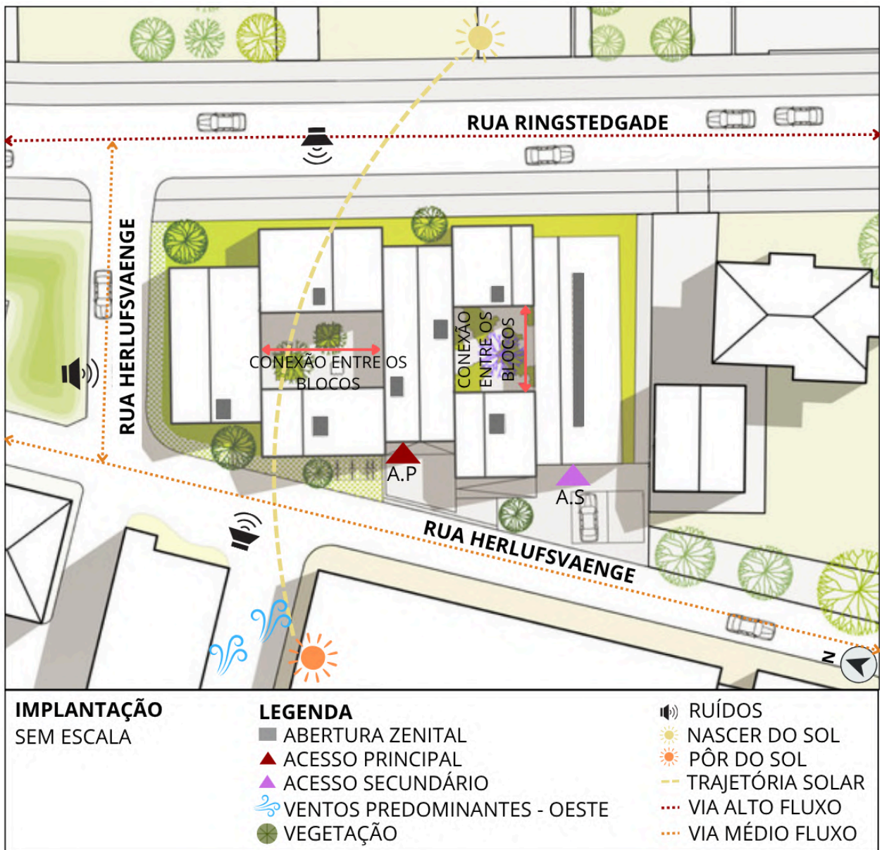
Figura 10 - Implantação com condicionantes climáticas e acessos.
