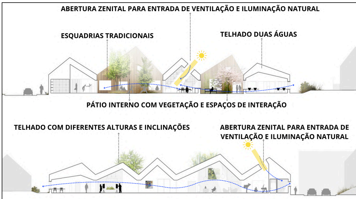
Figura 19 - Cortes esquemáticos humanizados com análise da composição e condicionantes climáticas.
