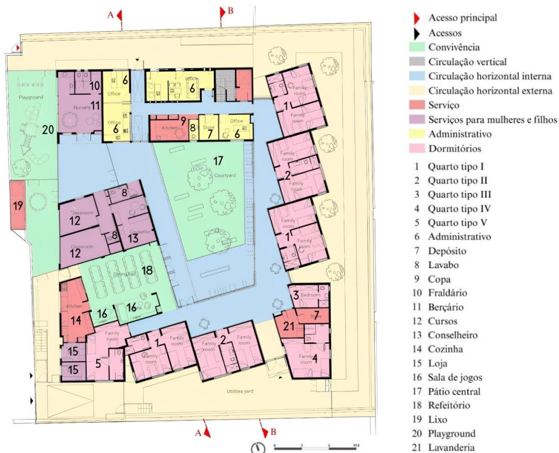
Figura 9: Planta baixa setorizado pavimento térreo
