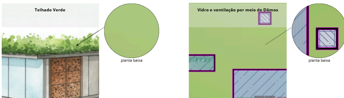
Figura 58 - Telhado e suas representações
