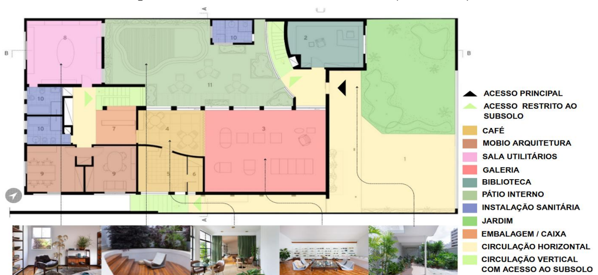
Figura 37 - Planta baixa do térreo setorizada (sem escala)
