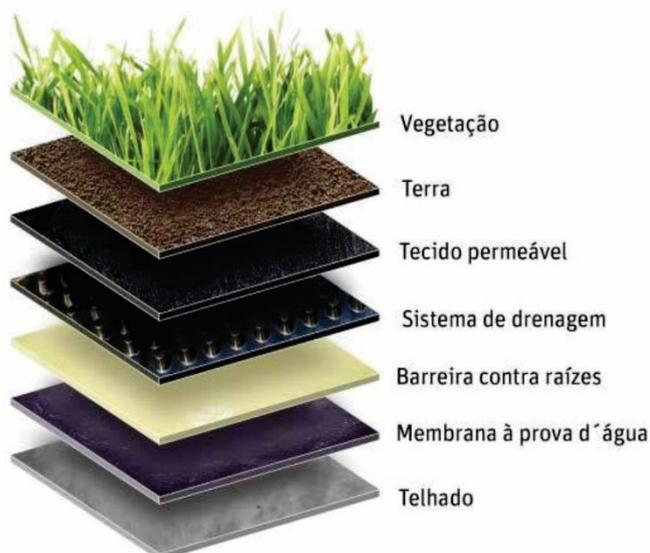
De acordo com a figura acima, é possível notar as camadas que compõem o telhado verde e como funciona a impermeabilização e drenagem do mesmo.
